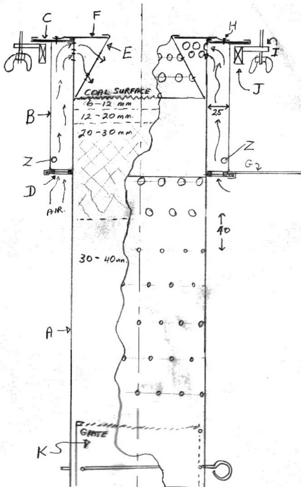
**FIG 1** COMBUSTION UNIT
