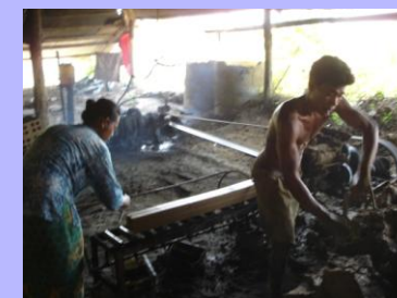
A gauche : Vu sur une presse à vis lors de la fabrication de briques de construction
