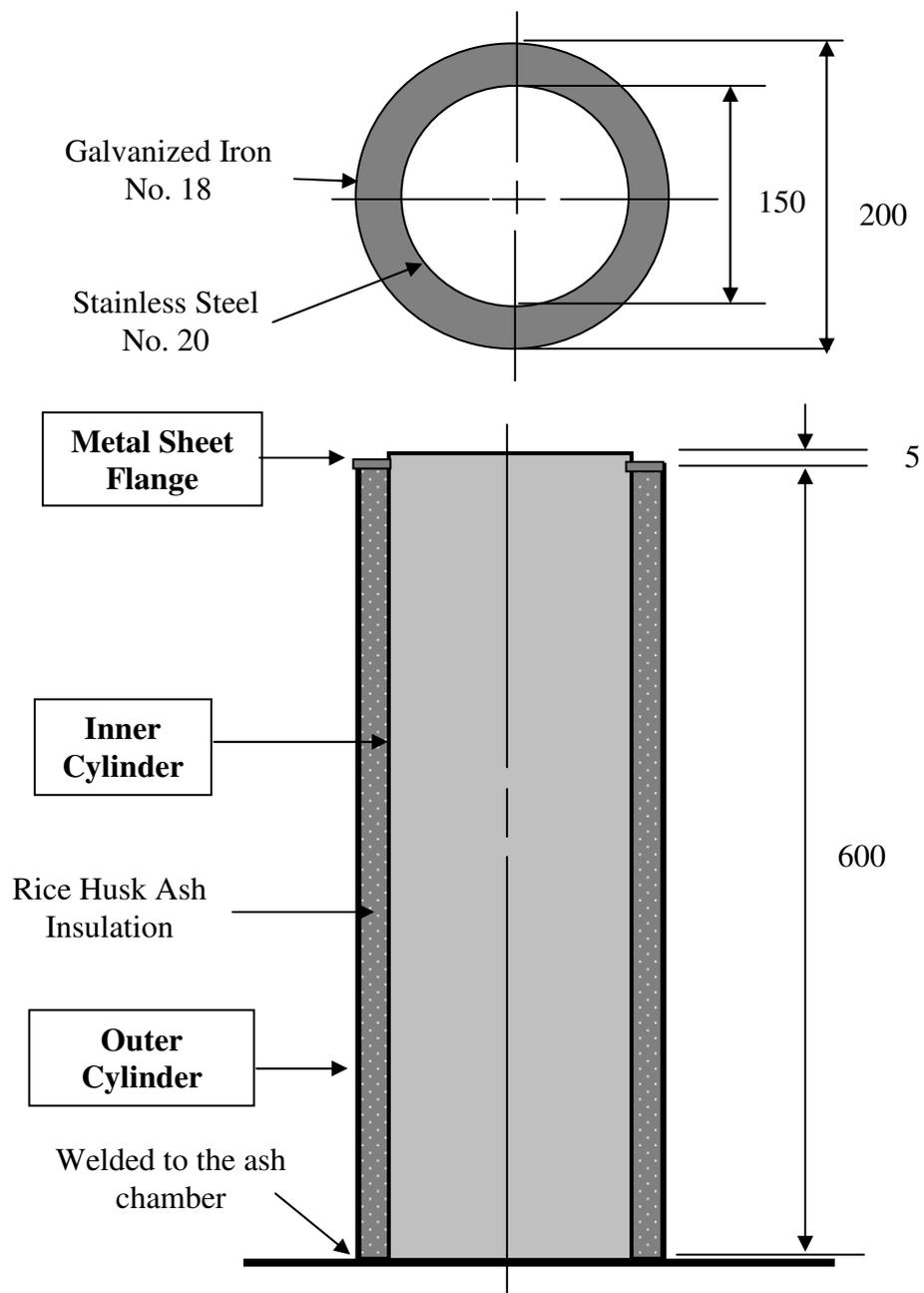
**DETAIL OF THE GASIFIER REACTOR**
